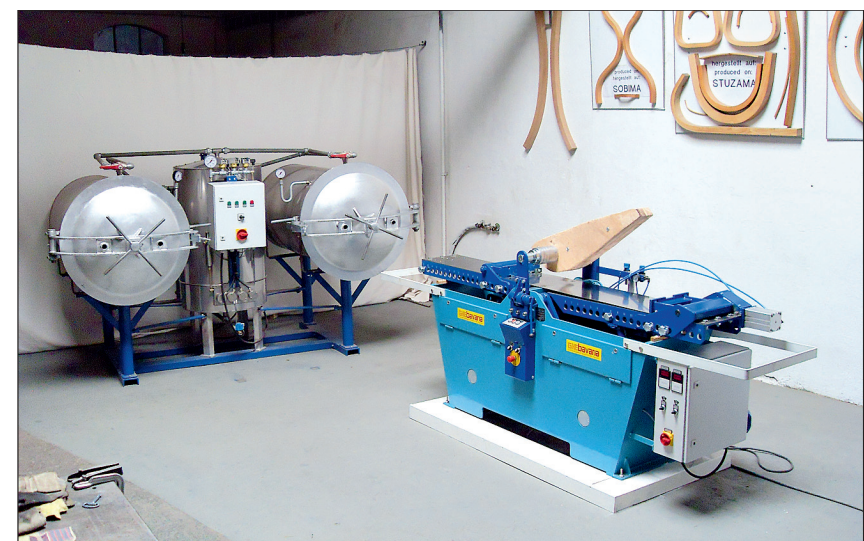
Vollholz-Biegeanlage. Links Dämpfanlage, rechts Biegemaschine
