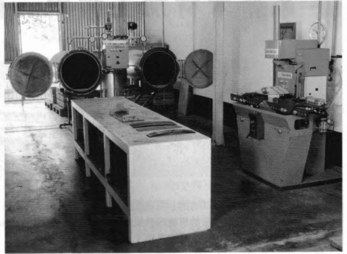
图5 椅子零件弯曲的成套设备:左为蒸气发生器,右为弯曲机(图片:GHE Bavaria公司)
