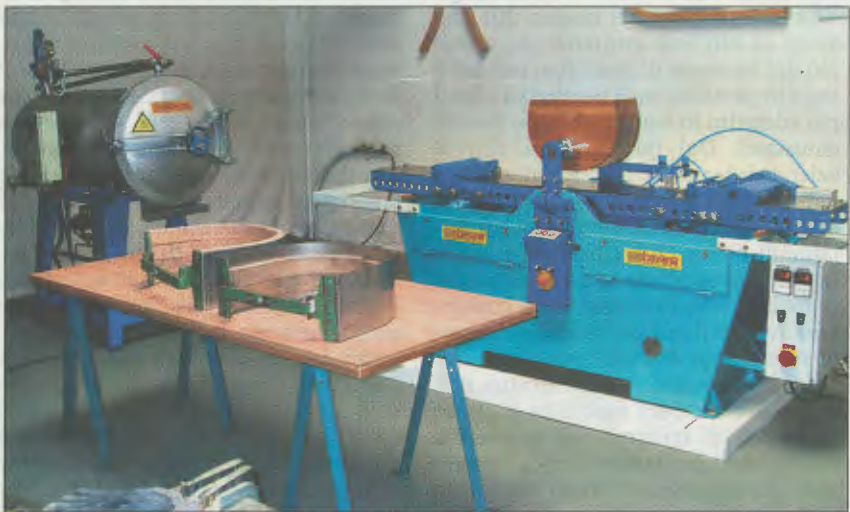
Postazione di curvatura con caldaia compatta, piegatrice „Stuzama II“ della GHE Bavaria e tavolo da lavoro con morse di piegatura. Foto: GHE Bavaria
