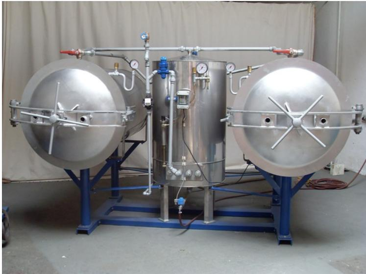
Dampfgenerator mit 2 Kesseln
