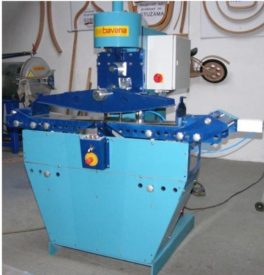
**Stuzama VP** – Vollholzbiegemaschine für offene, symmetrische Biegungen in einer Ebene von Werkstücken mit einer Länge von bis zu 1.300 mm in anwenderfreundlicher Konstruktion. Schnelles Beladen und Entnehmen von Werkstücken durch Modellwelle mit fliegender Lagerung (vorne offen).
